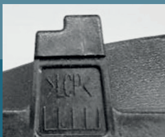
wypraska z formy z powłoką SIGAAN Px bez ubytku materiału
